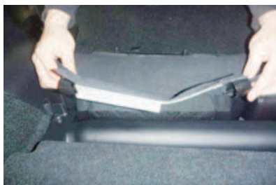
8 再びシートを倒して13ページ3番でピンを外した生地を引き出します。引き出すと13ページ5番～7番で外したプラスチックも一緒に引き出せます。
