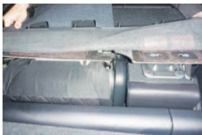
9 シート背面のバックボードを外します。バックボードはツメとピンで固定されています。(11番、12番参照) ツメを破損させないように慎重に取り外します。
