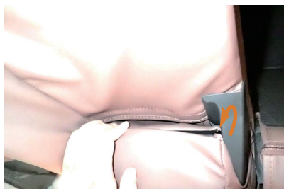
25 アームレストを倒してアームレストの付け根部分でブラフックを固定します。
