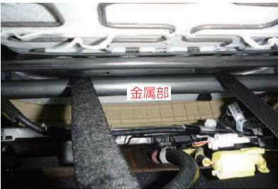
**8** 図はシート後方から見たシート底面です。7番で通したベルトを、シート底面を通して後ろ側へ引き出します。この際、図の金属部の上にベルトを通すようにして下さい。
