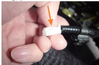
8 カプラーは、図の矢印方向にツメを押しながら引き抜くようにすると外せます。
