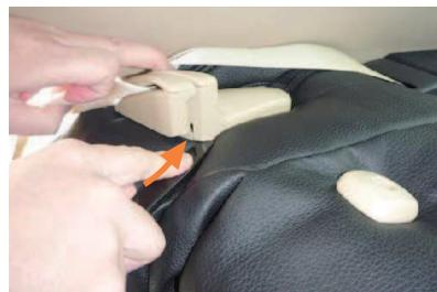
6 4番でシートベルトの台座をかわした生地を、台座の隙間に入れ込みます。
