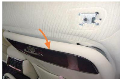
11 ネジを外したバックボードは、押し下げるようになると固定が外れます。
