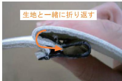
4 プラフックの固定方法は、カギ状のフックに板状のプラスチックを生地と一緒に折り返して、挟み込み固定します。
