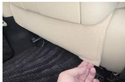
4 次に、シート背面のバックボードの下側に付いている生地を外します。
