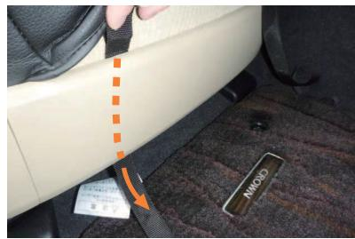
18 カバー前部に付いているベルトを、シートとプラスチックパーツの隙間を通して下さい。
