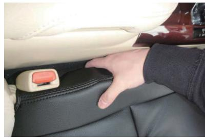
16 シートの内側面に付いているシートとコンソールの隙間を隠す生地の上から、カバーをマジックテープでシートに直接固定します。
