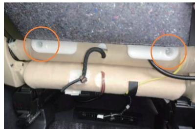
10 配線を外し、生地をめくり上げると図の○位置にネジが見えますので、ドライバーを使用しネジを外します。
