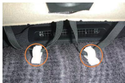
5 生地は、図のようなクリップでシート底面に固定されていますので、クリップを外してください。
