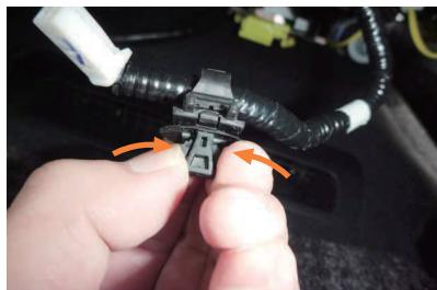
9 配線を固定しているバンドは、図の矢印方向にツメを押し込みながら引っ張ると外せます。
