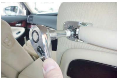
2 カバーを外すと、中にボルトがありますので、ソケットレンチを使用してボルトを外します。 (10mm)
