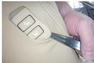
12 助手席背もたれ内側面にある、パワーシート操作用スイッチ部分を、カバーの加工穴から取り出します。
