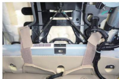
6 引き出した生地に付いているマジックテープベルトを、図のようにシートのフレームに巻き付け固定します。
