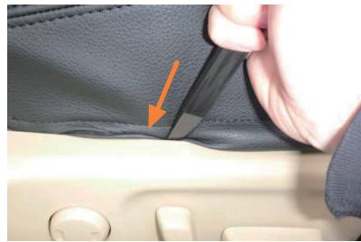
17 カバー外側面の生地を、シートとプラスチックパーツの隙間に入れ込みます。
