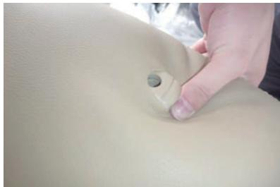
2 カバーの加工穴からヘッドレストの台座部分を取り出します。生地の伸びを利用して横から潜り込ませるように取り出します。
