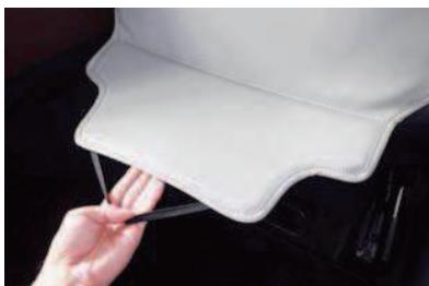
12 カバー背面下部の生地に付いているゴムを5ページ1番で外した生地が固定されているシート裏のプラスチックフックに引っ掛け固定します。
