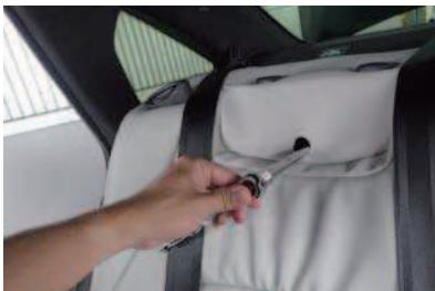
55 全てのボルトの穴位置が合っていることを確認した後、ボルトを固定していきます。
