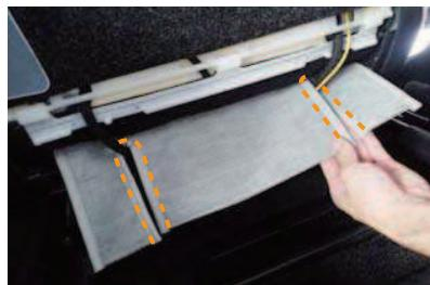
4 入れ込んだ生地を背面側から引き出します。座面と同様に、カバーの切れ込みで配線をかわすようにして下さい。
