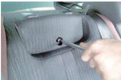
7 こちらのボルトもソケットレンチなどを用いて運転席側、助手席側共に外します。ソケットは12mmを使用します。
