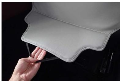
**12** カバー背面下部の生地に付いているゴムを5ページ1番で外した生地が固定されていたシート裏のプラスチックフックに引っ掛け固定します。
