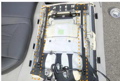
**15** シートの背面で上下のベルト2本を固定します。
