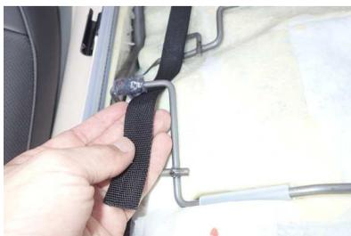
**14** 10番で金属部分の内側を通したベルトはシート背面中央部分の金属部分でも内側を通します。
