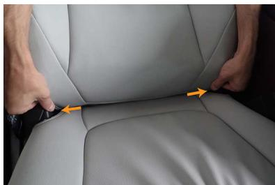
**9** シートを後ろに倒し、付け根の端までかぶさるように、カバーを広げます。
