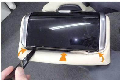
**7** ドリンクホルダーの下の隙間に生地を入れ込みます。
