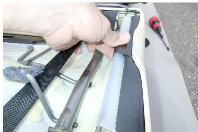
**16** シートカバーの側面に付いているブラックを純正シート表皮を固定しているフックの上から図の用に引っ掛けて固定します。
