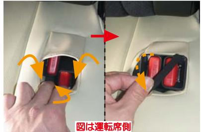
11 シートベルトバックル収納部にカバーの加工穴と位置を合わせて、フチに沿って生地を入れ込みます。入れ込んだ生地をマジックテープで直接シートに貼り付けて固定します。収納部後ろ側の生地の内側に、ゴムが付いています。ゴムは2個あるシートベルトバックルを一緒に通して、バックルの根元まで入れ込みます。こうすることで、生地が浮かないように抑えられます。
