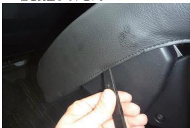
18 部材はヘラなどを使用してしっかりと入れ込みます。これによりカバー側面の生地の浮きなどが抑えられます。
