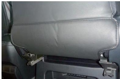
20 金属フックはシート裏の金属部分に引っ掛けで固定します。固定後は図のようになります。
