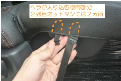
16 オットマン側面の生地裏に、図のような小さい部材が付いています。こちらはオットマンのフチに図のようにヘラが入り込む隙間が一部分のみあるので、その隙間に部材を入れ込みます。
