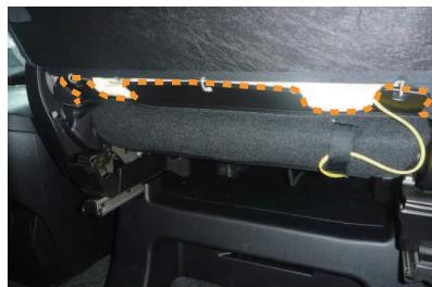
14 10番で引き出した生地に付いているフックを固定します。シート背面下の図の点線部分にフックを引っかけて固定します。
