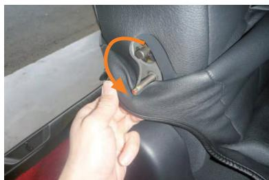
5 アームレストを外した後の軸部分は突き出しているので、カバーをかぶせる際に慎重にかわします。生地を引っ掛けたりすると、破れたり傷が付いたりするので、ご注意下さい。
