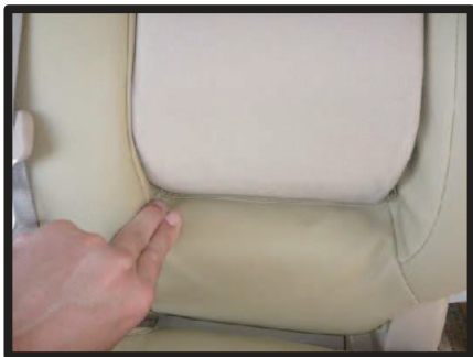
⑬アームレストの付け根部分の角に、生地を入れ込みます。
