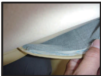
⑮アームレスト下の生地には固定が無いので生地が浮くことがあります。生地の浮きを押さえる対策案として生地裏に両面テープを貼ります。
