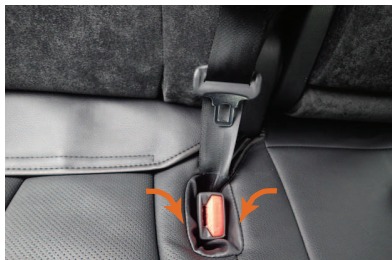
16 中央のシートベルト部分の生地を中に入れ込みます。
