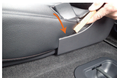
14 内側側面はプラスチックカバーの中に生地を入れ込みます。
