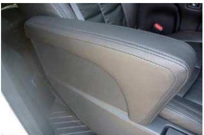
18 真上からアームレストを押し込みしっかりと固定します。生地の端がめぐり上がってきただけは、ヘラ等で入れ込み調整して下さい。
