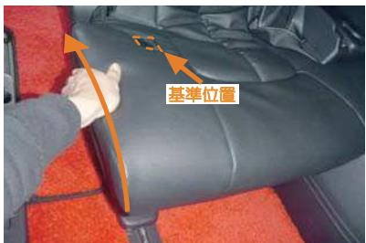
4 シートを車体側に固定してカバーのラインを整えます。シートベルトバックルが収納されている位置と、カバーの加工穴を基準に合わせるようにすると、正常なラインにカバーが装着できています。
