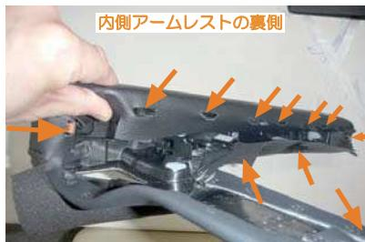
11 内側アームレストはシート側に6か所、最後に1か所ずつ、中央側に2か所、シート側付け根部分に1か所、カバーの切込み穴があります。それぞれアームレスト裏にある、アームレスト固定用のツメに引っ掛けるように固定します。
