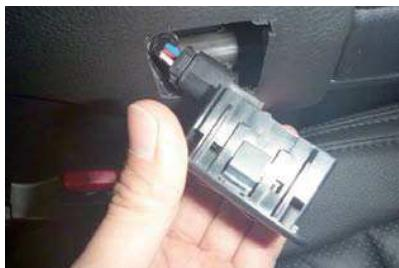
22 電動シートのスイッチ本体をカプラーにはめ込み元に戻します。
