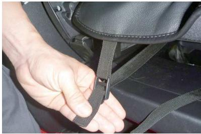
12 シートの背面からベルトを引き出します。引き出したベルトを5ページ5番で引き出した生地に付いているバックルに通して固定します。
