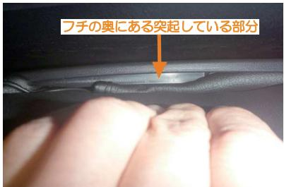
5 カバー内側面の生地をシートとプラスチック部のフチからさらに奥へ入れ込みます。シートのクッションを浮かしてフチの中を覗いてみると、矢印位置に突起している部分があります。その奥へ生地の端を入れ込み固定します。
