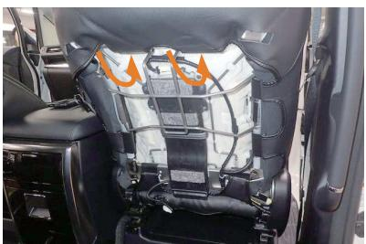
15 カバー背面の上側も、シート表皮を固定しているフックの上からカバーのフックを引っ掛けで固定します。（2力所ずつ）
