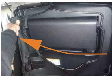
3 シートを跳ね上げて、シート裏の脚の部分をかわすようにカバーをかぶせます。
