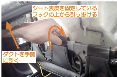
13 中央のフックはシート背面にあるダクトの内側を通して固定します。ダクト部分を手前側に引いて、その隙間からフックを通して純正のシート表皮を固定しているフックの上から引っ掛けで固定します。
