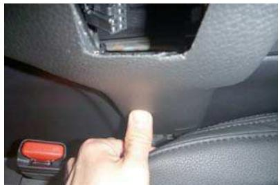
19 内側アームレストは始めにシート側付け根のツメを固定穴に合わせます。
