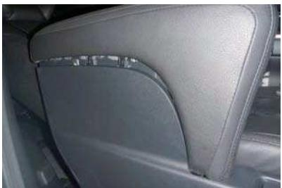
17 アームレスト全体のツメの位置を確実に合わせます。窓側・シート側を合わせて、もう一度16番で合わせた先端のツメがずれていないかを確認して下さい。
