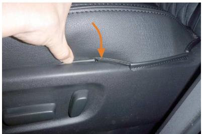
4 カバー外側面の生地をシートとプラスチック部のフチに入れ込みます。
