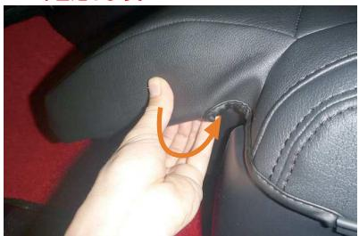
6 オットマンの付け根辺りに付いているフックを、生地と共に180度向きを変えて、オットマン付け根のフチにはめ込み固定します。オットマン内側のフックも同様に固定します。
