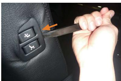
17 助手席側は内側面にパワーシートのスイッチがあります。スイッチのフチにヘラなどを使用して生地を入れ込みます。
