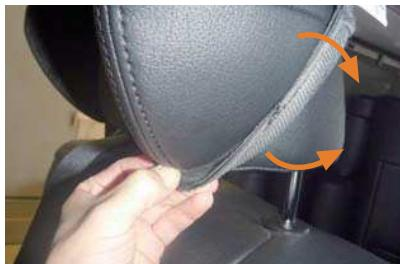
23 裏返した生地を慎重にヘッドレスト全体にかぶせます。生地のフチをヘッドレストに引っ掛けるように固定します。
