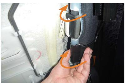
14 カバー背面の両端も、シート表皮を固定しているフックの上からカバーのフックを引っ掛けで固定します。（2力所ずつ）
