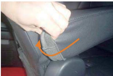
2 アームレストのラインからずれないようにカバーを全体にかぶせて、軸の部分にカバーを引っ掛けるようにかぶせます。
