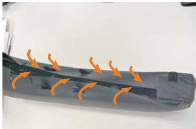
13 両面テープを貼った生地の端は内側に巻き込み、アームレストの裏側内部に直接貼り付けて固定します。アームレスト表面のライン、生地の張りを意識して固定して下さい。
