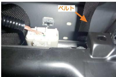
11 7番で引き出したベルトをシートの裏を通してシート背面側へ入れ込みます。この際シート裏にある配線や、金属部品の上にベルトを通すようにします。
