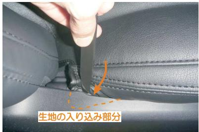
9 シート付け根の外側部分は隙間が大変狭くなっています。生地をプラスチック内側の矢印の方向へ向けて入れ込むことで、生地がきれいに入り込みます。
