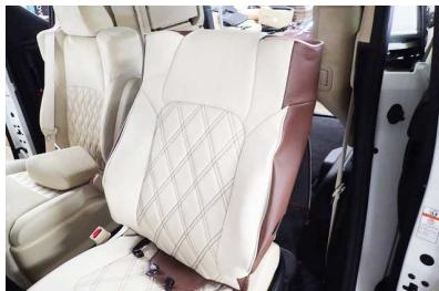
1 アームレストを10mmのソケットレンチを使用して外した後、両側面に付いているファスナーを開け、シート全体にカバーをかぶせます。
