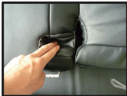
⑪シートを表側に向け、シートベルトの収まる部分の生地を入れ込み、形を整えます。
