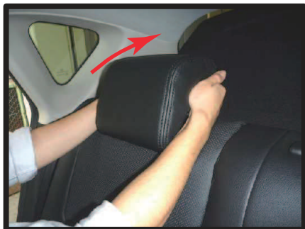
②カバーを矢印の方向へゆっくりとかぶせていきます。
