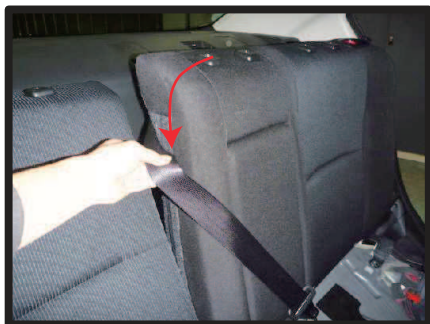
①中央席用のシートベルトを矢印の方向へかわしておきます。
