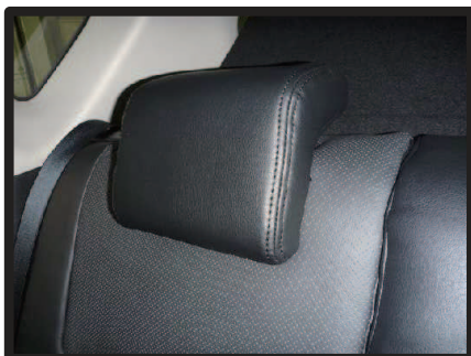
⑤カバーのラインを整えて2列目中央ヘッドレストの完成です。
