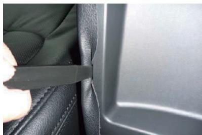
3 アームレストの隙間にカバー側面の生地を入れ込みます。
