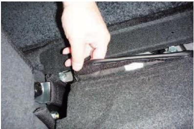
7 15ページ3番でかぶせた生地を後ろ側から引き出し、マジックテープでシートに直接固定します。
