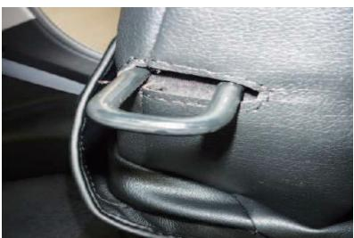
5 背もたれ内側面には、中央席固定用の金具がありますので、カバーの加工穴から取り出します。
