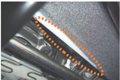
2 シートの底面を見ると、図のようにシート本体の生地がプラフックで固定されています。
