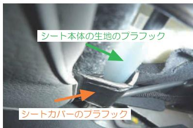
3 シート本体の生地を固定しているプラフックの上から、カバーのプラフックを引っ掛けで固定します。
