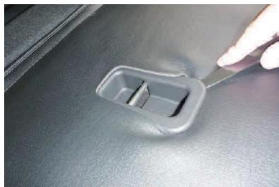
14 シート背面のチャイルドシート固定用具の隙間に生地を入れ込みます。
