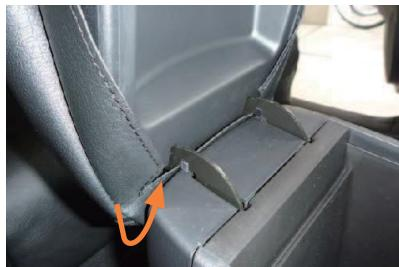
1 1列目アームレスト（コンソールBOX蓋）を開き、カバーを図のように引っ掛けるようにします。
