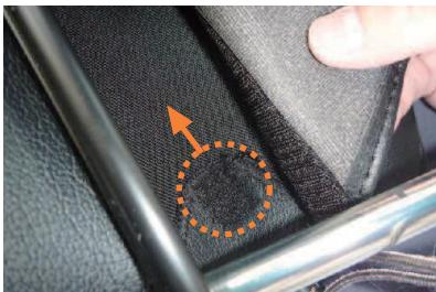
7 ヘッドレストをシートから外し、ヘッドレスト裏で、カバーを内側へ寄せながらマジックテープを留めます。
