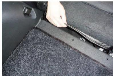
13 12番で外した生地をめぐり上げ、カバー前側から通してきた生地を引き出し、マジックテープでシートに直接固定します。
