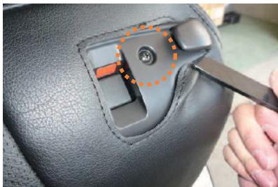
10 リクライニングスイッチ部の隙間にも生地を入れ込みます。この際、○部のネジをプラスドライバーで緩めておくと、作業がしやすくなります。
