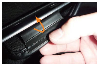
12 5ページ2番で取り外した逆の手順で、シート底面の金属部にプラフックを固定します。
