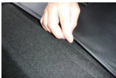
8 カバー背面に付いているマジックテープをシートに直接固定します。
