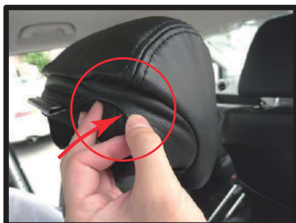
⑪ ヘッドレスト後ろ側の角部分を無理にかぶせようとするとうカバーが破れる恐れがありますので、図の矢印方向にヘッドレストを押しつぶすようにしながらカバーをかぶせて下さい。
