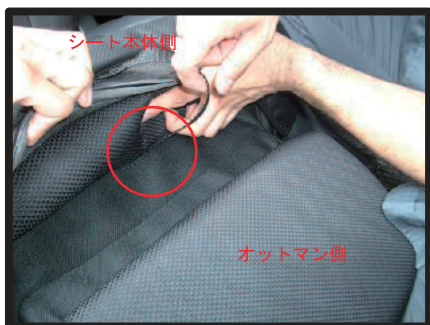
⑧オットマンとシート本体の隙間に、2～3cm程度の切れ込みが開いています。フロントの3本あるベルトの内、真中のベルトを通して座面後ろへと抜き出し背面のバックルと固定します。両サイドの2本も裏面を通して、バックルと固定します。
