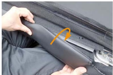
26 シート背面下側のフック状のプラスチックパーツと、カバーの下側の板状のプラスチックパーツを背面側から引き出して固定します。生地の端を図のように折り返して、生地と一緒にカバーのプラスチックパーツを純正のプラスチックパーツに入れ込みます。
