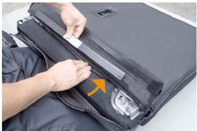
25 固定を外した板状のプラスチックパーツをシート背面下側のシート表皮の内側に入れ込みます。
