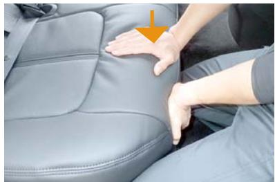
50 シート前側のフックを、車体の受け側のフックの位置と合わせて、上から押し込み固定します。39番の説明通り、車体の受け側に布などをかぶせている場合は、それらを外してから作業を行って下さい。
