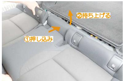
20 ①シートをラゲッジ側に少し押し込み、②シートの付け根を持ち上げるとシート裏のフックが外れます。これでシートと車体の固定が外れました。
