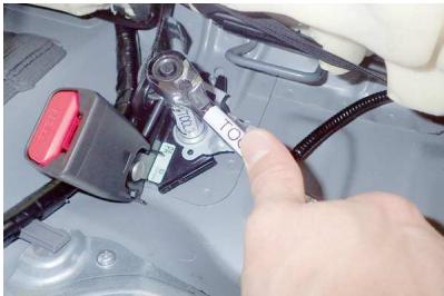
49 シートベルトバックルを元通りに固定します。
