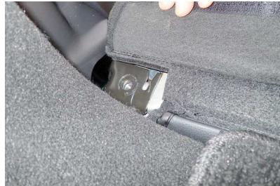
53 背もたれのボルト穴と、車体側の固定用金具のボルト穴の位置を合わせます。
