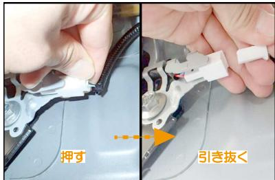
14 シートベルトバックルの横につながっている配線を外します。
