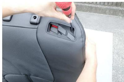
5 シートベルトのガイド部分に付いているネジを、ドライバーを使用して緩めます。
