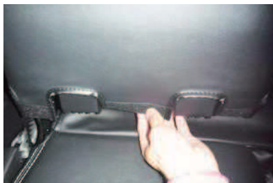
10 フタを閉じて、中央席下部と座面の隙間にマジックテープ部分を入れ込みます。
