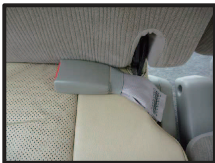
⑥シートベルトバックルを元に戻すと図のようになります。
