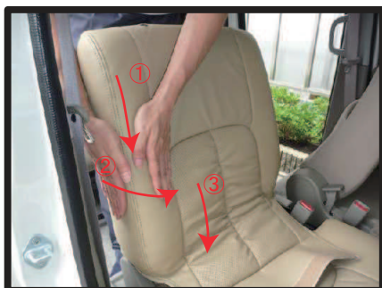
⑧図の①～③の手順で生地をなで下ろし、背もたれ中央下に寄った生地を座面と背もたれの間隙から背面に引き出します。この作業を繰り返してシートに密着させるようにカバーのシワを無くしていきます。
