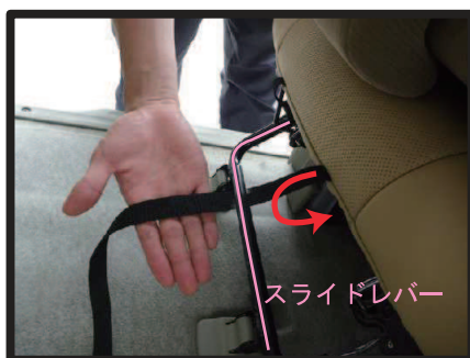
⑮座面前側に付いているベルトをスラ イドレバーをかわして後ろに持って 行き、3ページの②同様、座面後ろ に付いているベルトのバックルに通 し固定します。
