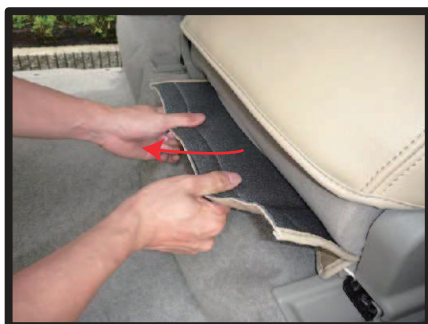
⑨⑦で入れ込んだ生地をシートの背面から引き出します。
