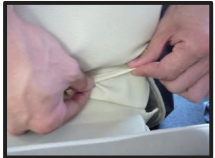
⑪内側面の座面カバーの生地を、背もたれカバーの中に入れ込みます。
