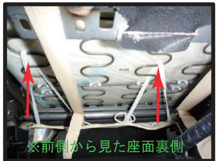
⑫カバー後ろ側の生地についているゴムを、図のように座面裏側の金属部に引っ掛け固定します。 ※引っ掛けにくい場合は、付属のS字フックを使用して下さい。
