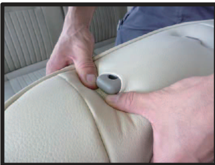
⑨ヘッドレストの台座部分を穴から取り出します。生地伸びを利用して横からもぐり込ますように取り出します。無理に入ると破れる恐れがありますので注意して下さい。
