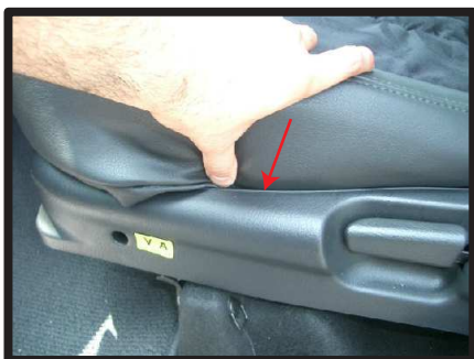
③側面は、シートとプラスチックカバーの隙間に生地とヒモを入れ込んでいきます。
