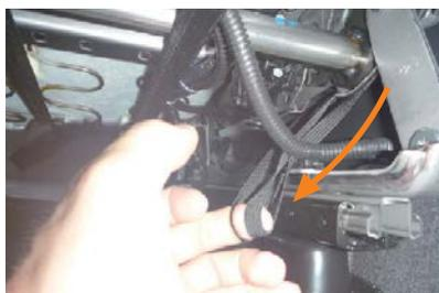
**11** シート裏側の図の隙間からゴムを引き出します。
