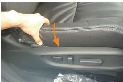
**8** シート外側面のシートとプラスチック部のフちに、生地を入れ込みます。
