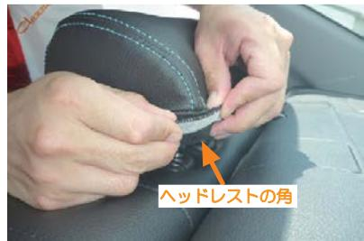
**11** 2列目中央ヘッドレストの後方にカバーをかぶせていく際は、図のヘッドレストの角を指で押しながら、カバーをかぶせるようにして下さい。
