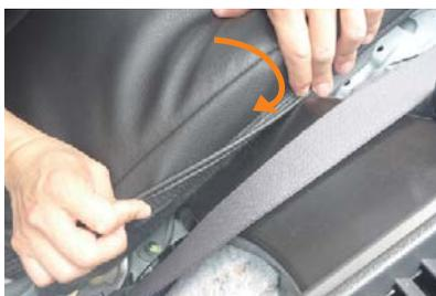
**11** シート側面の生地をマジックテープで直接シートに貼り付けて固定します。
