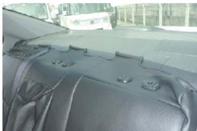
**7** カバーの加工穴からヘッドレストの台座を全て取り出します。
