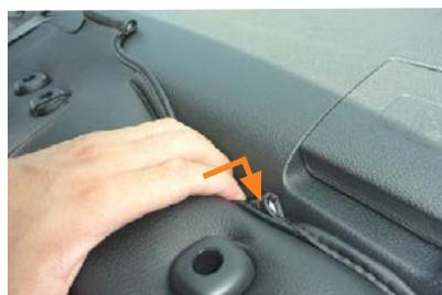
**9** シート上のシートと車体の隙間に生地を入れ込みます。
