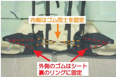
**15** 12ページ7番で入れ込んだ生地が付いているゴムに、S字フックを取り付けて固定します。内側のゴムはゴム同士をS字フックでつないで固定し、外側のゴムはS字フックをシート表皮を固定しているリングに引っ掛けて固定します。
