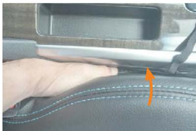
**10** シートの内側面とコンソールボックスの土台の隙間に、端にゴムの付いた生地を入れ込みます
