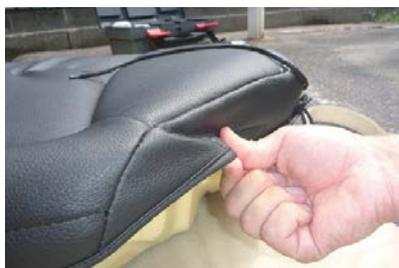
**9** カバー側面後方に付いているマジックテープを、直接シートに貼り付けて固定します。
