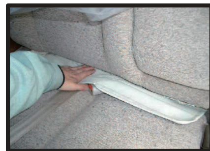
⑧背もたれと座面の間にカバーを取り付けます。中央のシートベルトをよけてマジックテープで固定します。
