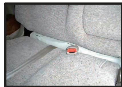
⑨図のように取り付け出来れば完成です。助手席側も同様に取り付けして下さい。
