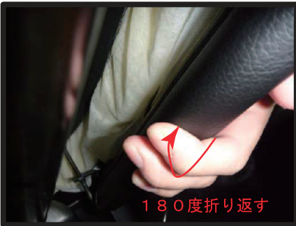
③②で確認したシート本体に固定されているプラフックの上から、カバーのプラフックを固定します。
