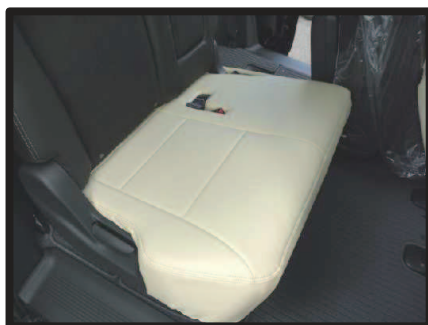
⑫カバーのラインを整え、2列目運転席側座面の完成です。助手席側も一部形状が異なりますが同様に取り付けます。
