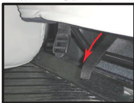
⑪シート下からベルトを取り出し、カバー前側で1列目と同様に固定します。※ベルトは図のようにシートスライドバーの上側を通して下さい。
