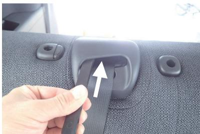
2 プラスチックパーツをヘラなどを使用して矢印の方向へ押し、プラスチックパーツを固定している後ろ側のツメを外れます。
