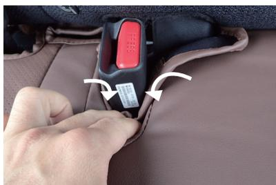
20 シート中央のシートベルトのバックルが出ているシートのフチに、生地を入れ込みます。この際生地の端に付いているマジックテープを直接シートに貼り付けて固定します。
