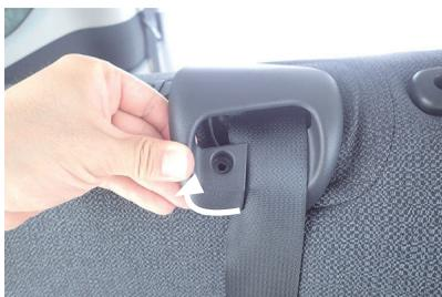
3 プラスチックパーツの隙間にシートベルトを通します。
