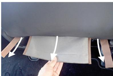
12 入れ込んだ生地とマジックテープをシートの背面から引き出します。※図は、SPADAグレードです。AIRグレードの場合、内側（左端）のマジックテープは、生地になります。
