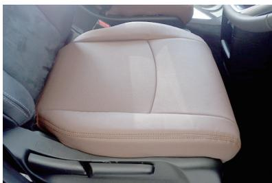
17 カバーのラインを整えて、1列目運転席座面の完成です。助手席も一部形状は異なりますが、同様の固定方法で取り付けます。
