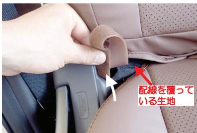
11 10番で入れ込んだ生地の両端に付いているマジックテープを、配線を覆っている生地をかわしながら、図の隙間に入れ込みます。※図は、SPADAグレードです。AIRグレードの場合、内側（右端）のマジックテープは、生地になります。
