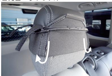
1 2列目両サイドのヘッドレストです。2列目のヘッドレストは、まず図のようにカバーを半分ほど裏返した状態で、ヘッドレストのラインに合わせてかぶせます。カバーは板状のプラスチックが付いている方が前側になります。
