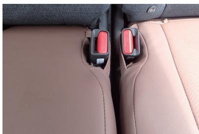
23 運転席側・助手席側のシートベルトのバックル部分は、必ず図のように固定して下さい。
