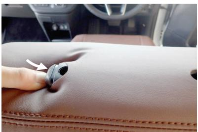
8 ヘッドレストの台座をカバーの加工穴から取り出します。始めに台座の片側のフチに生地をしっかりと入れ込みます。
