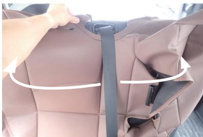
5 シートカバーを装着します。カバー背面のファスナーを開いて中央のシートベルトの内側にカバーを通します。
