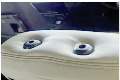
9 生地の伸びを利用して台座を取り出します。※革を使用したカバーでは、革がほとんど伸びないため生地の端が裂けてくる場合があります。生地は少し裂けても台座のフチに隠れるので、それ以上裂けないように慎重に作業を行って下さい。
