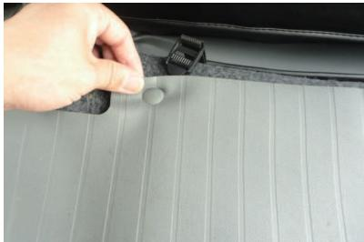
7 図の生地はネジで固定されていますが、ネジは抜く必要はありません。生地の切り込み部分からネジの頭をすり抜けさせて、12ページの6番で枠で囲んだ部分をめくり上げます。
