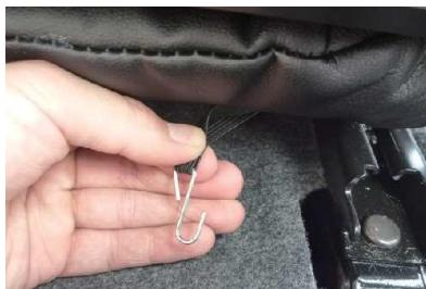
17 入れ込んだゴムをシート裏から引き出します。引き出したゴムに付属のS字フックを図のように取り付けて、シート裏の金属部分に引っかけて固定します。
