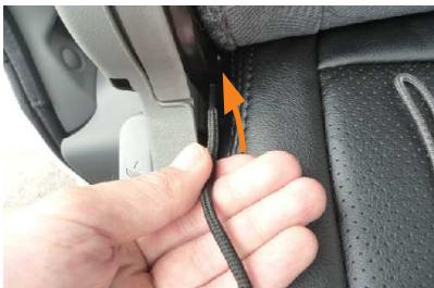
8 カバー外側面の生地から出ているヒモを、図のシートとプラスチック部の隙間に入れ込みます。
