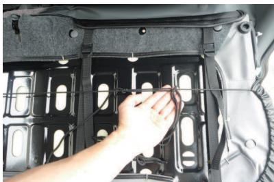
9 8番の状態でカバーの前後のベルト4本とカバーの側面から出ているヒモを固定します。
