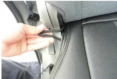
16 シートの付け根部分に付いているゴムを、シートとプラスチック部の隙間に入れ込みます。
