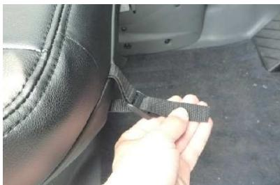
14 ベルトをシートの前側から引き出します。引き出したベルトをカバーの前側に付いているバックルに通して固定します。
