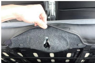
10 12ページの2番の作業で引き出した生地を直接シートに貼り付けて固定します。
