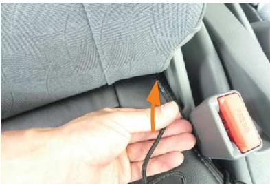
**9** カバー内側面の生地から出ているヒモを、図のシートとプラスチック部の隙間に入れ込みます。
