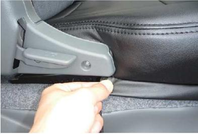
**7** カバー側面の生地をプラスチック部の隙間に入れ込みます。ネジは生地を入れ込み締め直します。
