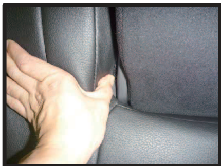
⑬アームレスト付け根部分の生地を図のように入れ込みます。
