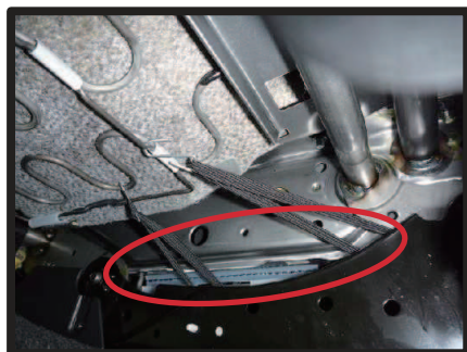
⑧シート裏の図です。ゴムは図の赤丸部分の隙間を通して、シート裏の金属部分に引っ掛け固定します。固定が出来たら、シートを前後にゆっくりスライドさせ、シートの動作にゴムが干渉していないか確認して下さい。
