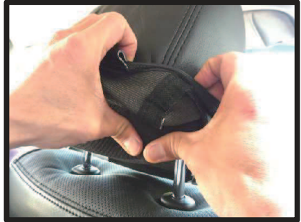
②カバーをヘッドレスト全体にかぶせていきます。カバーは非常にタイトに出来ていますので、図のようにヘッドレストを押し潰しながら慎重にかぶせて下さい。
