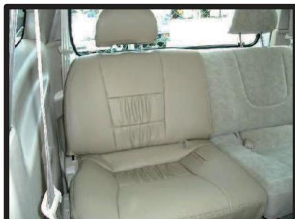
③1列目と同様に背もたれカバーを取り付け、跳ね上げ固定用ベルトの位置に穴をあけてベルトを元通りに取り付けます。
