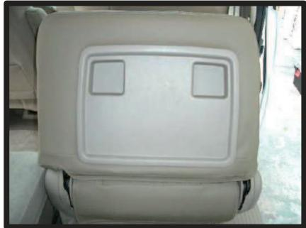
⑥背もたれ裏側のテーブルの隙間にカバーを入れ込みます。前側から引き出したマジックテープ部分を固定します。
