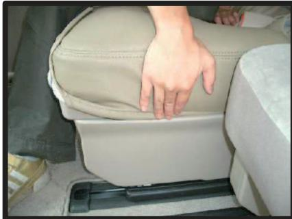
②座面内側のスponジ部分をプラスチックカバーの隙間に入れ込みます。
