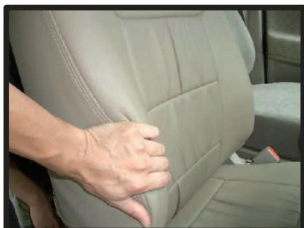
③側面のしわを中央に寄せるようにしてシートとカバーをなじませます。
