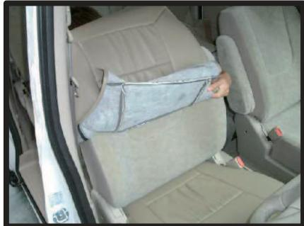
①ヘッドレストを外し、背もたれカバーをかぶせます。横のファスナーを開き、マジックテープ部分を折り返して左右均等に引き下げていきます。
