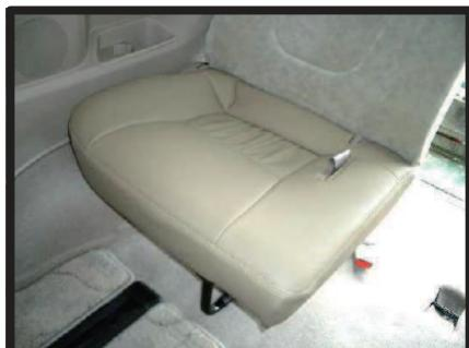
①座面カバーをかぶせます。2列目座面と同様に取り付け、座面下にマジックテープで固定します。
