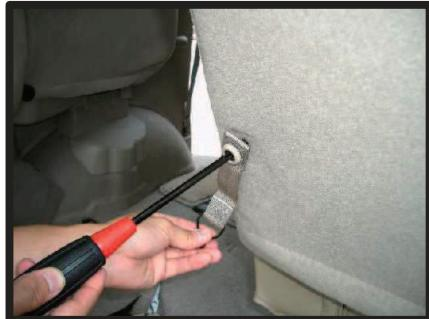
②背もたれカバーを取り付ける前に裏側の跳ね上げ固定用ベルトを+ドライバーで外します。
