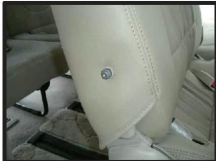
⑦リクライニングレバーの軸部分にカッター等で穴をあけ、軸を取り出してレバーを元通りに取り付けます。
