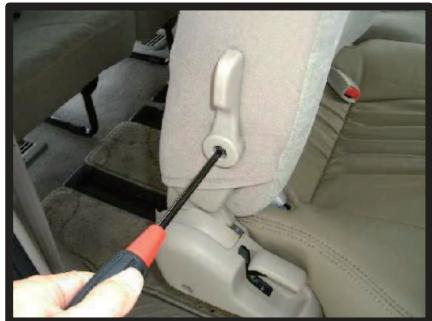
④背もたれカバーをかぶせる前にリクリーライング用レバーを+ドライバーで外します。
