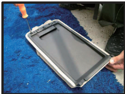
⑪-⑩アームレストのフタの部分もボックス部分同様に、プラスチックカバーを取り外します。 +ドライバーで取り外せます。
