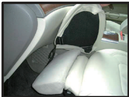
⑦オットマンのカバーをかぶせます。 ヒモが出ている方が前側です。
