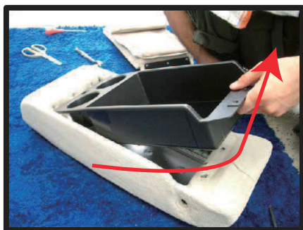
⑪-⑤全てのネジを取り外した後、プラスチックのボックス部を、矢印方向に引き抜くと、簡単に取り外せます。
