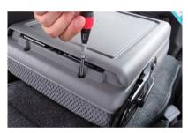
2 バックテーブル後方にもネジが2ヶ所ありますので、外します。 4ヶ所のネジを外す事で、バックテーブルが取り外せます。
