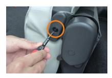
10 背もたれ付け根のプラスチックカバーのネジを外します。
