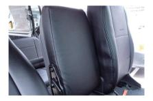
6 取り外した逆の手順で、バックテーブルを 元に戻します。この際、ネジ穴が生地で隠 れていますが、生地ごとネジを締めて下さい。カバーのラインを整えて、1列目中央 席背もたれの完成です。
