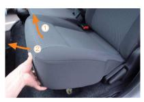
5 座面の前側を持ち上げてから、全体を前に 引くと座面が外れます。 座面を取り外す際、車体等に傷を付けない ようご注意ください。
