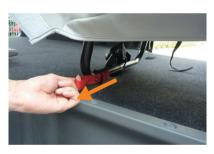
5 背もたれを前に倒し、座面後方下に付いて いるベルトを手前に引き、ロックを解除し ます。
