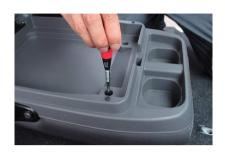
1 中央席背もたれを倒し、バックテーブルを 外します。バックテーブルのフタを開け、 ニヶ所のネジを外します。
