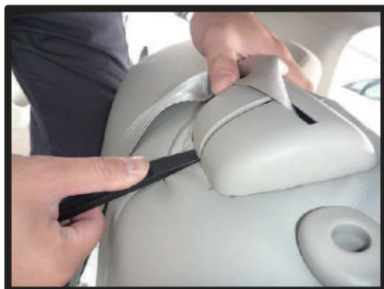
⑬シートベルトの台座部の隙間にヘラ等を使用し、生地を入れ込みます。
