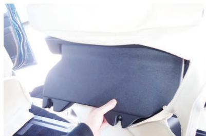
6 シートを跳ね上げて、カバー裏の穴位置でシートの脚をかわします。
