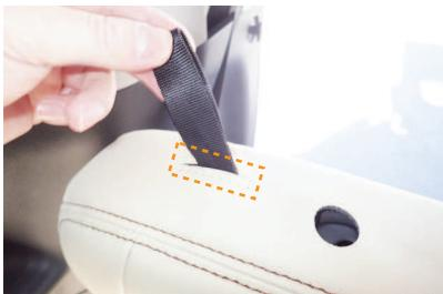
2 カバーの加工穴から、リクライニング用ストラップを取り出します。
