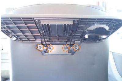
3 次に、背面のバックテーブルを取り外します。バックテーブルを跳ね上げるとナットが4箇所見えます。（図の○位置）ソケットレンチ（8mm）を使用して、全てのナットを外すと、バックテーブルが取り外せます。
