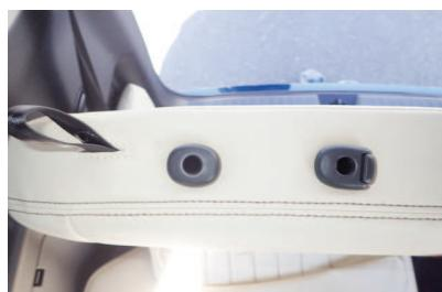
6 カバーの加工穴から、ヘッドレストの台座を取り出します。
