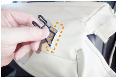
7 シート跳ね上げ時に車体に固定する為のベルト（シート背面側に収納されています）を、カバー底面の加工穴から取り出します。
