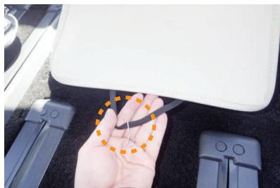
15 カバー背面の先端には、ゴムが付いています。図のように、付属の金属フックをゴムに取り付けます。
