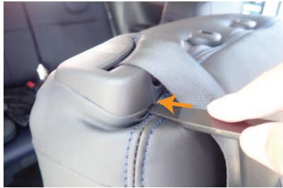
7 シートベルトの台座とシートの隙間に生地を入れ込みます。
