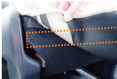
14 カバー背面に付いているマジックテープをシートに直接貼り付け固定します。
