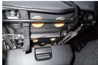
10 引き出したベルトをカバー前側に付いているバックルに通し、固定します。ベルトの固定方法に関しては 11 番を参照してください。
