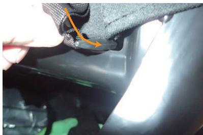
8 シートの隙間にバックルを通し、下側から取り出します。
