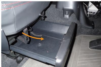
9 シート前側からベルトを引き出します。シート下にボックスが付いた車は、図のようにボックスを引き出しておくと、作業がしやすくなります。
