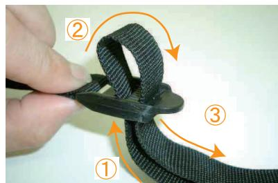
11 ベルトの通し方は、図の①～③の順番にベルトをバックルに通し、引くことでベルトが締り固定されます。
