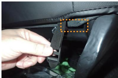
7 カバー前側に付いているバックルをシートの隙間（図の点線部）に通します。
