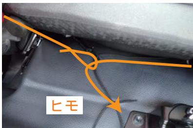
5 カバー側面の左右のヒモを、背面下部で結んで固定します。
