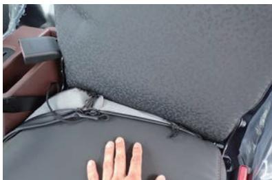
2 背もたれと座面の隙間に生地を入れ込みます。背もたれの角度を調整して、入れ込みやすい位置で作業を行ってください。
