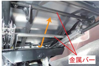
22 ページ16番で引き出した生地に付いているベルトをシート裏から前側に通し、カバー前側に付いているバックルと固定します。ベルトはシート裏にある金属バーの上を通してください。ベルトの固定方法は23番を参照してください。
