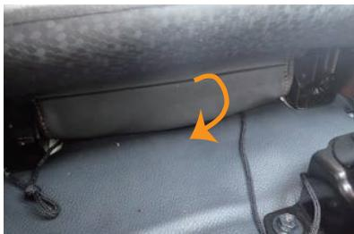
3 入れ込んだ生地をシートの背面から引き出し、座面下部と床の隙間に、生地を潜り込ませるようにかぶせます。
