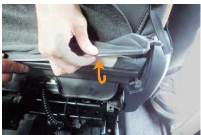
**15** シート背面下部で固定されている純正のプラフックの固定を外します。
