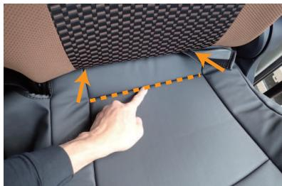
1 シートの段になっている部分に分割ラインを合わせ、ラインがずれないように、背もたれと座面の隙間に生地を入れ込みます。
