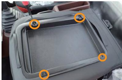
5 背面のプラスチックパーツを固定している4カ所のネジを、プラスドライバーを使って外します。
