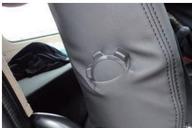
9 ランバーサポート用のダイヤルをカバーの加工穴から取り出します。
