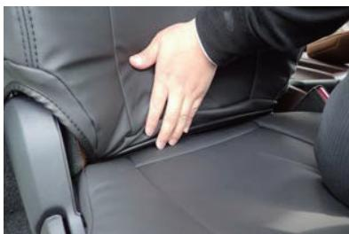
20 背もたれと座面の隙間に生地を入れ込み、背面側から引き出します。
