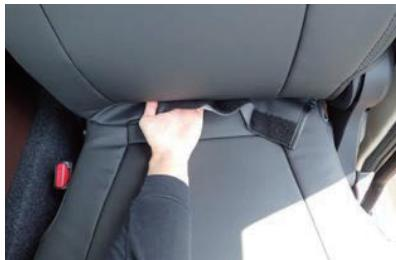
2 背もたれと座面の隙間に生地を入れ込み、背面側から引き出します。
