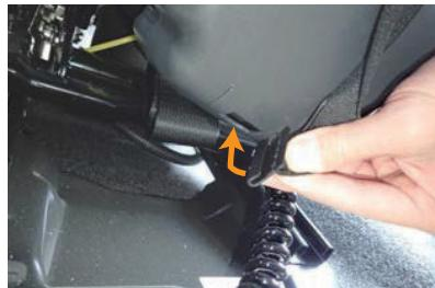
11 カバー背面下部の生地に付いているゴムの先に付いたプラフックを、5ページ1番で外した純正プラフックが付いていた箇所に引っ掛け固定します。
