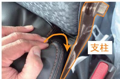
4 側面の生地をシートと背もたれと座面をつなぐ支柱との隙間に入れ込み、座面下部を巻き込むようにかぶせます。
