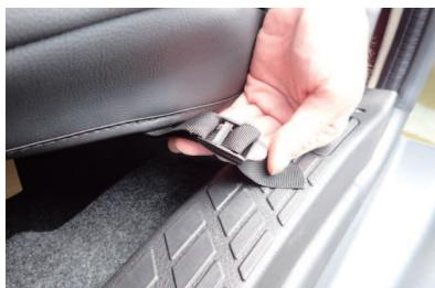
6 ベルトをシートの裏から外側に通し、カバーの外側に付いているバックルと固定します。ベルトの固定方法は、8番を参照してください。
