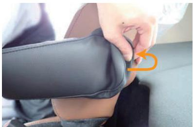
3 アームレスト側面のフタを戻し、カバーをアームストの後ろに引っ掛けるようにかぶせます。
