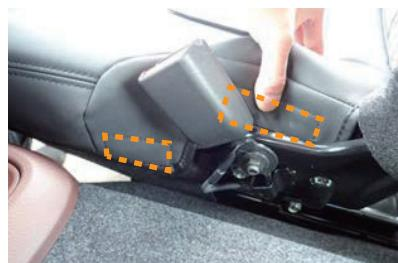
12 カバー内側面のシートベルトバックル付近に付いているマジックテープを、シートに直接貼り付けて固定します。
