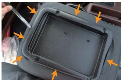
6 生地および固定用ゴムチューブを背もたれとプラスチックパーツの隙間に入れ込みます。
