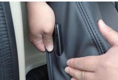
19 ランバーサポート装備車は穴をあけた後、ファスナーを一度開け、穴からレバーを取り出した後にファスナーを閉め直します。
