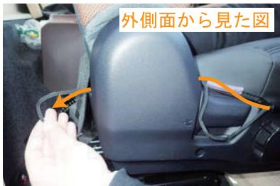
19 カバーの両側面から出ているひもを、シートの軸部分から、背面に引き出します。
