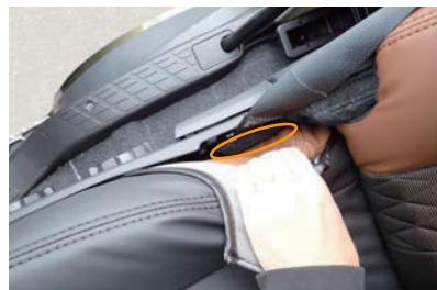
11 ヘラ等を使用し、カバー外側面の付け根に付いている固定部材を、図の隙間に入れ込みます。
