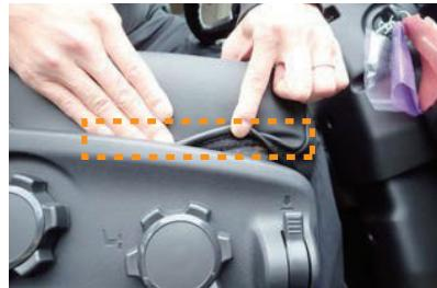
10 カバー外側面の生地裏に付いているマジックテープをシートに直接貼り付けて固定します。シートの高さを一番高い位置にすると作業が行いやすいです。
