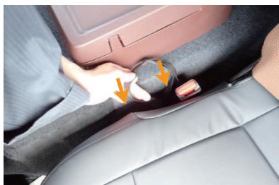
5 カバーの内側に付いているベルトを隙間に入れ込み、シート裏から引き出します。
