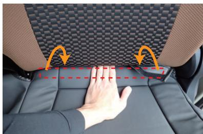
2 入れ込んだ生地に付いているマジックテープをシートに直接貼り付けて固定します。図のように、手を入れて指で包み込むようにするときれいに仕上がります。
