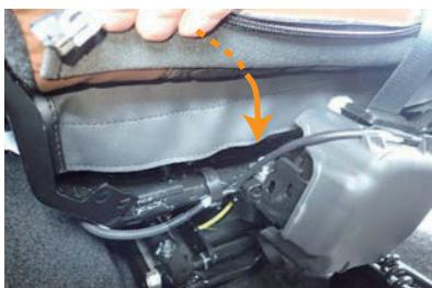
9 入れ込んだ生地に付いているマジックテープをシートに直接貼り付けて固定します。この時、5ページ2番で外したファスナーの付いた生地の片側は、カバーの内側に隠れている状態（カバー装着後使用しない）です。
