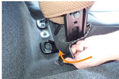
4 カバーの内側面後ろ側に付いているマジックテープをシートに直接貼り付けて固定します。
