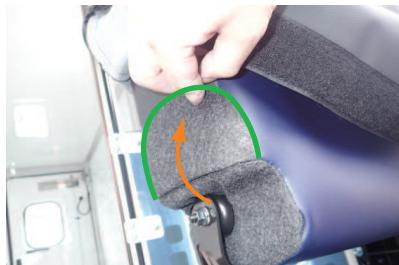
4 シート内側面の金属部分を覆う目隠し用生地を、図のようにめくり上げ、カバーの内側へ入れ込みます。
