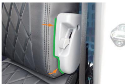
11 リクライニングレバー部のプラスチックパーツの隙間に、生地を入れ込みます。
