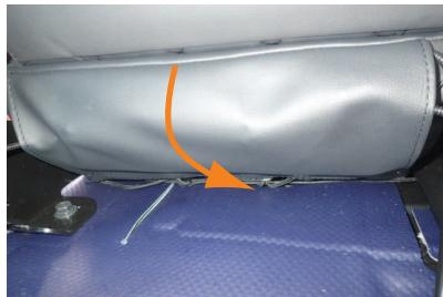
22 引き出した生地に付いているマジックテープをシートに直接貼り付け、固定します。
