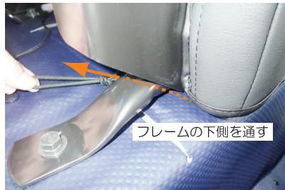
18 カバー内側面に付いているヒモを、フレームの下側を通し、後ろ側へ引き出します。
