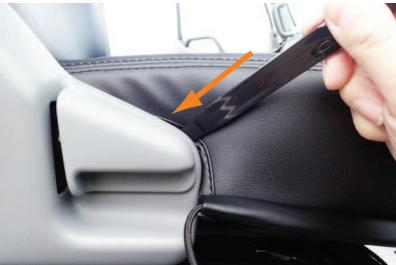
7 カバー外側面の生地をリクライニングレバ一部の隙間に入れ込みます。
