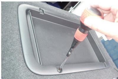
1 始めにシート背面のバックボードを取り外します。バックボードは4カ所のネジで固定されていますので、プラスドライバーを使用し、ネジを外します。
