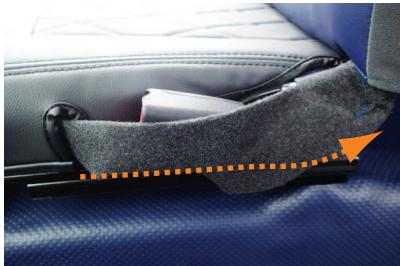
13 シート内側面に付いているヒモを、図のようにシートに沿わせるようにしながら後ろ側へ通し、⑨番と同様にシートとシートレールの隙間に引っ掛けるようにします。
