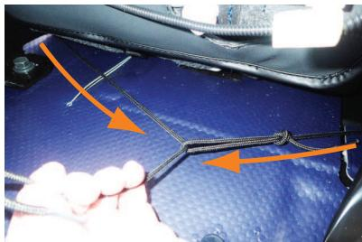
19 カバー外側面のヒモを、シート下から後ろ側へ引き出し、内側面のヒモと結び留めます。
