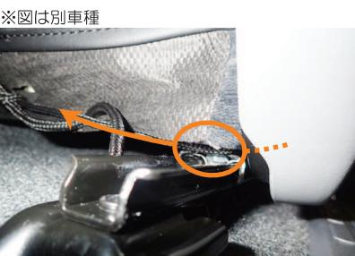
9 後ろ側へ通したヒモは、シートとシートレールの隙間（図の○位置）に引っ掛けるようにします。
