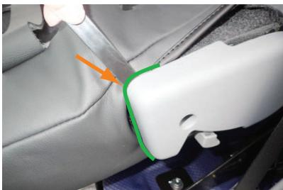
7 リクライニングレバー部のプラスチックパーツの隙間に、生地を入れ込みます。隙間が狭いので、ヘラ等でプラスチックパーツを浮かせるようにしながら生地を入れ込むと作業がしやすくなります。
