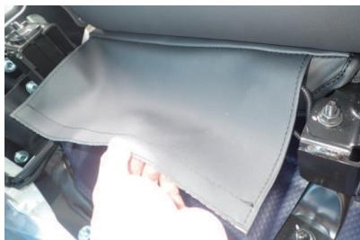
21 カバーに付いている図の生地は、4番でめくり上げた配線の目隠し用生地の代わりです。生地を、背もたれと座面の隙間から後ろ側へ引き出します。
