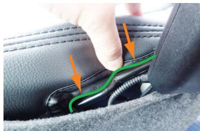
12 シート内側面の隙間（図の緑線部）に沿って、生地を入れ込みます。
