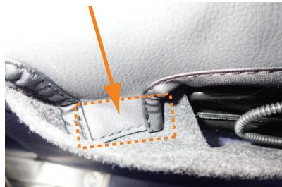
11 入れ込んだ生地に付いているマジックテープをシートベルトバックル収納部の底面に直接貼り付け、固定します。
