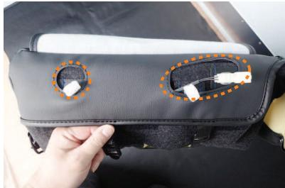
13 カバーの加工穴から、カブラーと配線固定具を取り出します。
