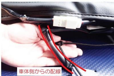
14 ⑧番と⑬番で両側面から引き出したヒモ同士をシート後ろ側で結び留めます。この際、図の配線の下側でヒモを結ぶようにして下さい。配線は、シートを前側にスライドさせると確認しやすくなります。
