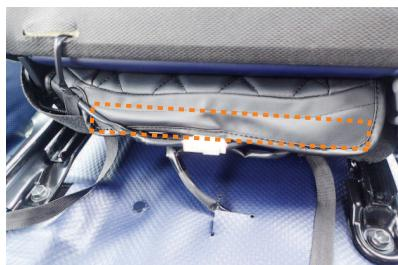
6 3番で引き出した生地に付いているマジックテープをシートに直接貼り付け、固定します。
