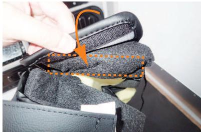
14 シート内側面の後ろ側に生地を巻き付けるようにしながら、生地に付いているマジックテープをシートに直接貼り付け、固定します。
