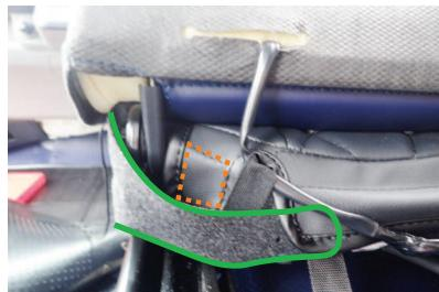
5 4番で配線をかわした生地に付いているマジックテープをシートに直接貼り付け、固定します。この際、図の緑線で示した生地の内側に生地を貼り付けるようにして下さい。
