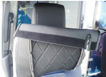
1 カバー内側面のファスナーを開き、半分程裏返した状態で、シートのラインに合わせてカバーをかぶせます。
