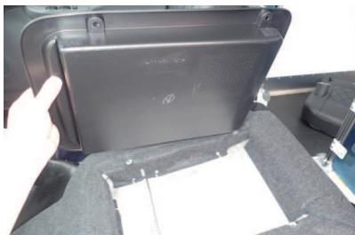
2 ネジを外すと、図のようにバックボードが取り外せます。
