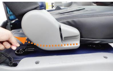
8 シート外側面に付いているヒモを、図のようにシートに沿わせるようにしながら後ろ側へ通します。
