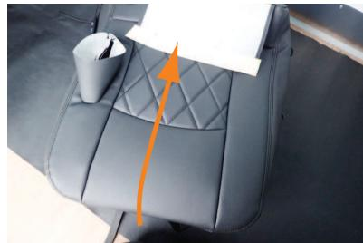
10 外したシートを作業の出来るスペースに運び出し、カバーをかぶせます。
