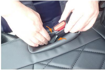
23 シートベルトバックル収納部の隙間に生地を入れ込みます。
