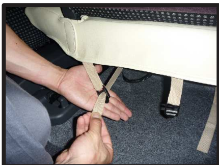
⑮座面の前後をベルトで固定します。カバーの前方に付けているベルトを座面裏を通し背面から引き出します。
