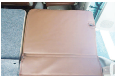
16 シート背面の図です。15Pの1番で外した生地を元通りに固定します。
