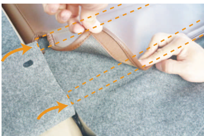
14 カバーの背面に付いているマジックテープを2か所直接シートに貼り付けて固定します。
