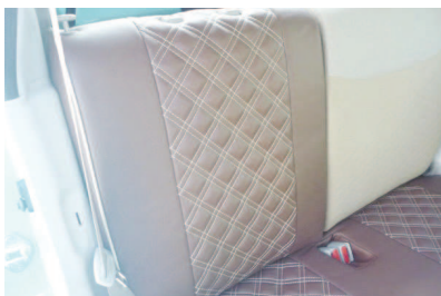
17 カバーのラインを整えて、2列目運転席側背もたれの完成です。助手席側の背もたれも同様に取り付けます。
