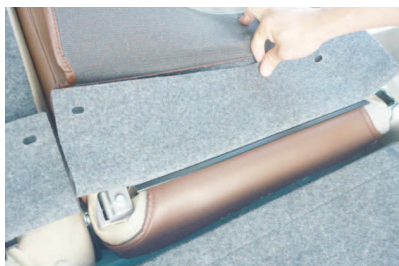
13 カバーの背面下を純正シート表皮のフックとカバーのブラフックで固定した図です。
