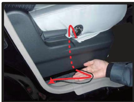
⑧ヒモは、プラスチックカバーの中を通して、下に引き出してから、背面に持っていきます。
