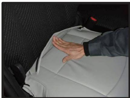
②背もたれと座面の隙間にカバーを入れ込みます。
