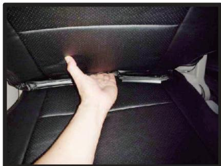
④大きなプラスチックフックが付いた部分を、背もたれと座面の隙間に入れ込みます。フックでカバーに傷を付けないようにご注意ください。
