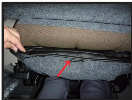
⑩マジックテープを固定する際、図のチャイルドシートのアンカー部分まで生地がかぶらないようにして下さい。
