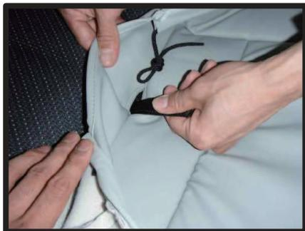
⑭助手席側の座面は、シートを持ち上げた状態で作業を行います。カバーをかぶせる前にストラップをカバーの穴から抜き出します。
