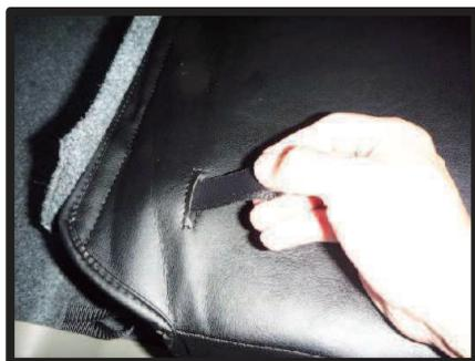
⑪背もたれ裏にあるストラップをカバーの穴から抜き出します。
