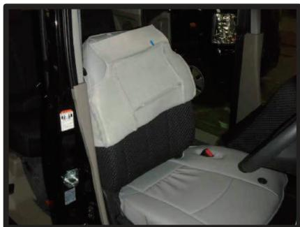
④ヘッドレストを外します。背もたれカバーを半分ほど裏返してシートにかぶせます。ヘッドレストの台座とカバーの穴位置を合わせ、肩口までしっかりかぶせます。
