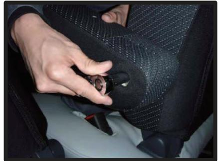
②ソケットレンチを使用してボルトを外します。
