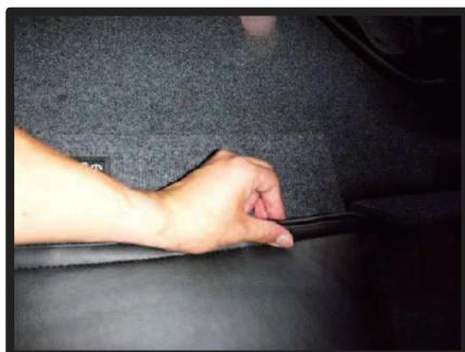
⑫背もたれ背面下のマジックテープを直接シートに貼り付けて固定します。
