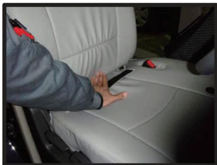
⑥折り返していた半分の左右均等に下まで引き下げ、背もたれと座面の隙間にカバーを入れ込みます。
