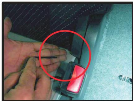
④カバー後ろ側に付いているヒモは、背もたれと座面の隙間に入れ込みます。
