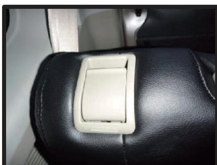
⑰カバーをレバーとシートの間に入れ込み、外したネジを元に戻すと図のように仕上がります。
