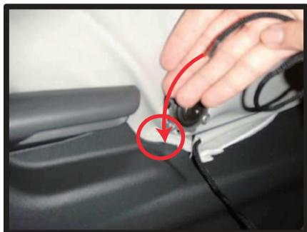
⑦カバー側面のヒモを、シートとプラスチックカバーの隙間に入れ込みます。
