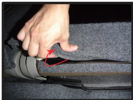
⑥背もたれ背面下で、シート表皮を固定している部分を外します。シートはプラスチックフックで固定されています。図の矢印方向に生地をめくるとフックの固定が外れます。
