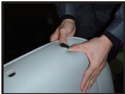
⑤ヘッドレストの台座部分を取り出します。生地伸びを利用して横からカバーをもぐり込ませるようにして台座部分を取り出します。
