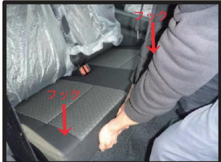
①2列目座面のカバーを取り付ける為にシートを取り外します。シートは図の矢印位置にフックで固定されています。フックの位置あたりを持ち上げて、シートを車体から外します。
