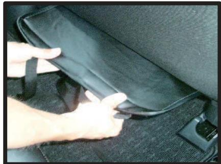
④入れ込んだ生地をシート背面側から引き出してマジックテープをシートの底面に直接固定します。
