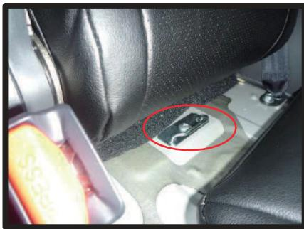
⑫2列目座面を車体に戻すときは図の○位置の金属部に5ページ⑤の○で示した金属部分を引っ掛けるようにして戻します。
