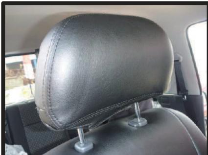
②左右交互に少しずつカバーを引き下げていきます。ヘッドレスト本体を入れ込むように押さえるのがコツです。
