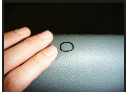
④2列目ヘッドレストがある車には背もたれ上部に穴を開ける加工が必要です。指でヘッドレストの台座の位置を確認して台座の穴に沿ってペンで印を付けます。
