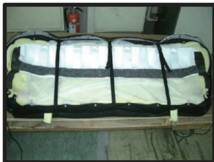
④シートを裏返しカバーの前後をベルトで固定します。
