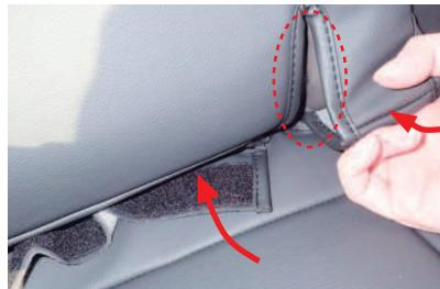
6 背もたれと座面の隙間に生地を入れ込みます。この際、図の○位置に通っている配線を、カバーのスリット位置でかわすようにして下さい。
