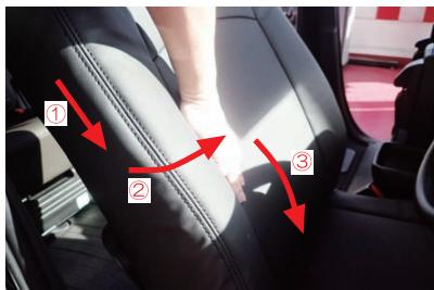
19 図の①～③の手順で、シート側面のシワを中央に寄せるようにしながら、馴染ませていきます。中央でたるんだ生地は、18番のように、シートの後ろ側から引き出します。
