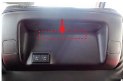
9 次に、上側の生地に付いている固定用部材を、シートバックアシストボードの隙間に入れ込みます。上側の方が下側に比べ、隙間が狭くなっていますので、慎重に作業して下さい。
