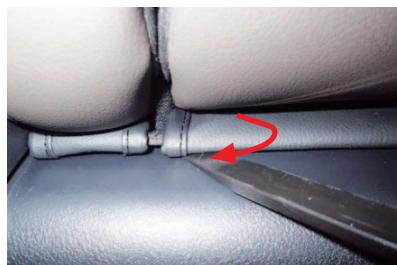
11 9番で引き出した生地の先端には、板状のプラスチックパーツが付いています。生地ごとプラスチックパーツを巻き込むようにしながら、10番で確認した純正シート地とプラスチックパーツの隙間に生地を挟み込み、固定します。
