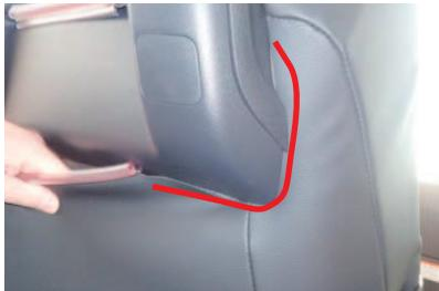
3 背面のシートバックアシストボードを、カバーの加工穴から取り出し、運転席側と同様に、隙間に生地を入れ込みます。
