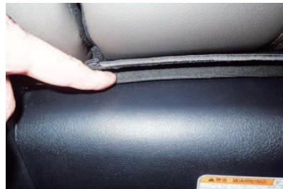
10 図で指し示した位置には、純正シート地がプラスチックパーツに固定されています。
