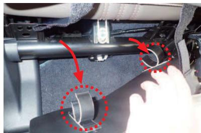
11 板状のパートは手前に引くようになると、フレームにはまっているプラスチックパート（図の○部）が外れ、取り外せます。
