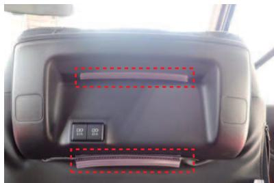
7 シートバックアシストボード部のカバーの上下には、固定用部材が付いています。
