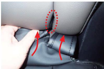
2 背もたれと座面の隙間に生地を入れ込みます。この際、図の○位置に通っている配線を、カバーのスリット位置でかわすようにして下さい。
