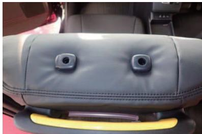
2 カバーの加工穴からヘッドレストの台座を取り出します。
