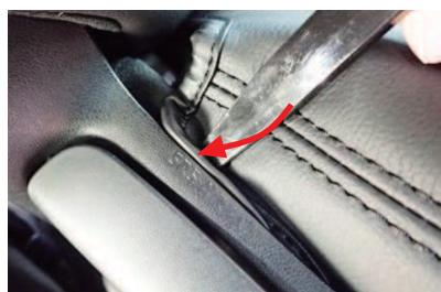
6 リクライニングレバー横の生地は、下方向には入り込まないので、図のようにシートに沿って、外側方向に生地を入れ込むようにします。
