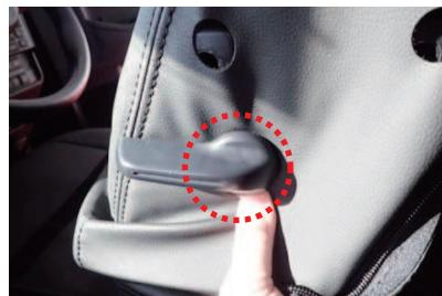
10 シート内側面に付いているランバーサポート用レバーを、カバーの加工穴から取り出します。
