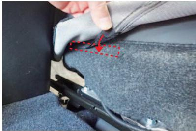
7 カバー内側面の生地に付いているマジックテープをシートに直接貼り付け、固定します。マジックテープには保護テープが付いていますので、外してから作業して下さい。始めに、図で示した位置に付いているマジックテープを固定します。
