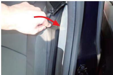
7 カバー側面の生地を、ヘラ等を使用し、シートと車体の隙間に入れ込みます。
