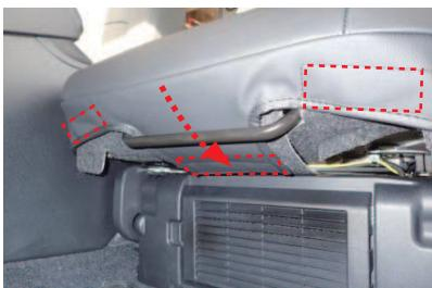
8 カバー前側の生地に付いているマジックテープ(図の□部)をシートに直接貼り付け固定します。中央部の生地は、図のようにシートスライドレバーの上側を通します。シートを前側にスライドさせておくと、作業がしやすくなります。
