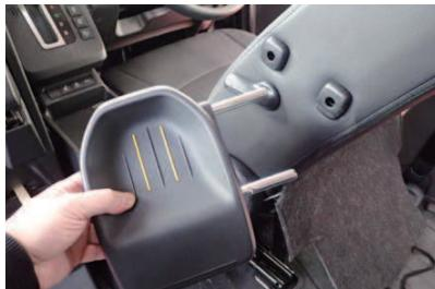
1 カバー装着前に、シート内側面に付いている料金トレイを取り外します。
