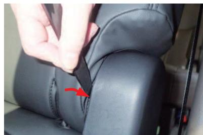
10 シートのヒンジ部の隙間に生地を入れ込みます。（両側面）
