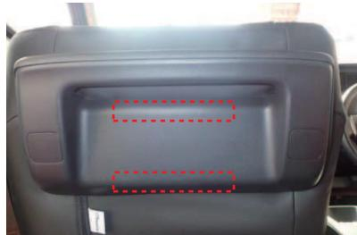
5 運転席側と同様に、カバーに付いている固定用部材を、シートバックアシストボードの隙間に入れ込みます。
