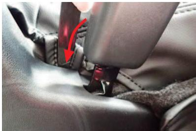
7 ヘラ等を使用し、シート内側面の隙間に生地を入れ込みます。
