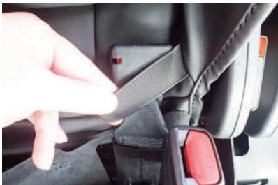
15 2番で取り外したシートベルトバックルをカバーに付いているゴムバンドに通し、固定します。
