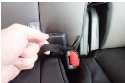
2 次に、バックルを固定しているゴムバンドから、バックルを抜き取ります。
