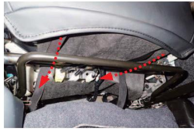
10 カバー前側の生地に付いているベルトを、座面裏を通して後ろ側から引き出します。ベルトは図のように、シートスライドレバーの上側を通すようにして下さい。ベルトは、4番で引き出した生地に付いているバックルに通し、固定します。
