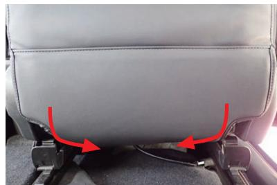
22 金属フックをシート裏側の金属部分に引っ掛け固定します。
