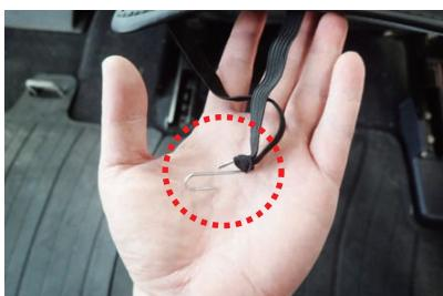
21 カバー背面下の生地には、ゴムが付いています。ゴムに付属の金属フックを取り付けます。
