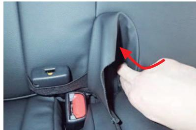
16 背もたれ中央のヒンジ部の隙間に生地を入れ込みます。
