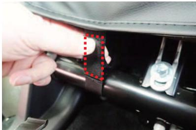
13 12番で巻き付けたマジックテープベルトを固定し、11番で外したプラスチックパーツを元に戻します。この際、プラスチックパーツに干渉しないよう、マジックテープベルトの位置に注意して下さい。
