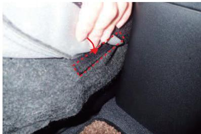
4 カバー内側面の生地に付いているマジックテープをシートに直接貼り付け、固定します。マジックテープには保護テープが付いていますので、外してから作業して下さい。始めに、図で示した位置に付いているマジックテープを固定します。
