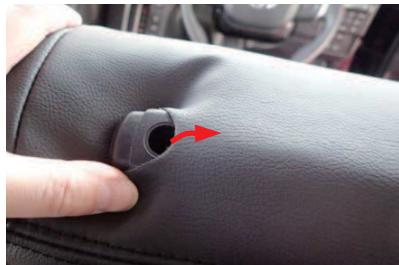
5 カバーの加工穴からヘッドレストの台座を取り出します。図のように、始めに一方の角から台座を取り出すようにし、生地の伸びを利用して台座全体を取り出します。
