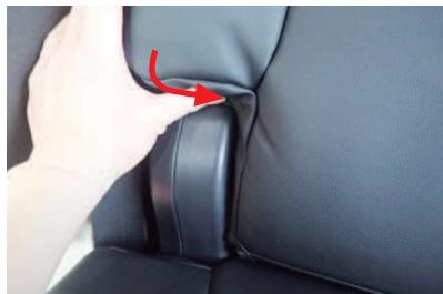
17 背もたれ両端のヒンジ部の隙間にも生地を入れ込みます。
