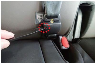
1 カバー装着前に、中央席用のシートベルトを取り外します。ヘラ等を使用し、バックル横の赤いボタンを押すと、ベルトがバックルから外れます。外れたベルトは一旦、背もたれの背面側に回しておきます。
