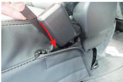
9 シートベルトバックル部の隙間に、生地を入れ込みます。
