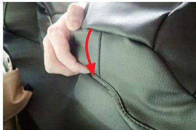
4 中央席ヘッドレストの後ろ側にあるプラスチック部の隙間に生地を入れ込みます。
