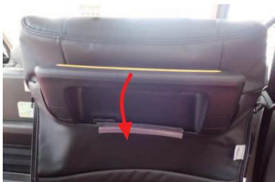
3 背面のシートバックアシストボードを、カバーの加工穴から取り出します。
