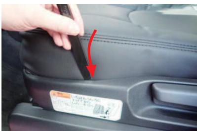
3 ヘラ等を使用し、カバー外側面の生地をシートの隙間に入れ込みます。
