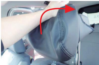
8 助手席ヘッドレストは、前側から後ろに引っ掛けるようにカバーをかぶせます。カバーに板状のプラスチックが付いている方が前側です。
