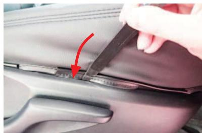
5 ヘラ等を使用し、カバー外側面の生地をシートの隙間に入れ込みます。
