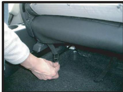
⑥座面カバーの前後についているベルトとバックルを固定します。
