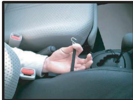
⑤付属品のS字フックを側面のゴムに引っ掛け、ゴムを伸ばしながらシートレールに干渉しないよう座面の裏に引っ掛けます。
