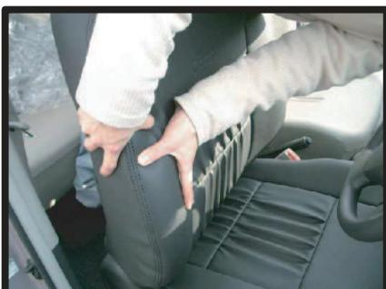
③側面のしわを中央に寄せるようにしてシートカバーを馴染ませながら、背もたれと座面の間に入れ込んでいきます。
