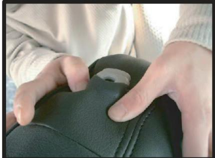
④ヘッドレストの台座部分を穴から取り出します。生地ののびを利用して横からもぐりこますように取り出して下さい。
