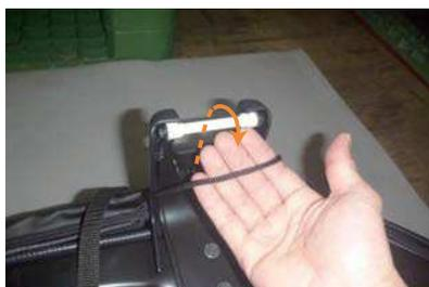
**8** シートを固定している軸部分のひもを、軸の内側にくるようにします。
