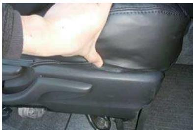
**12** 外側面に付いている固定部材を、生地と共にプラスチックカバーの隙間に入れ込みます。
