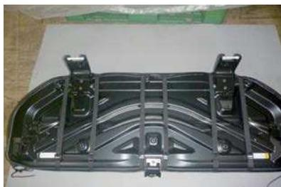
**7** シートを裏返して、前後のベルト6本を固定します。ベルトの固定方法は6ページ10番を参照して下さい。
