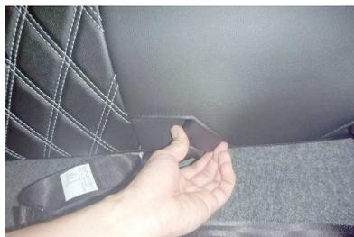
**22** シート中央のシートベルトとバックルをカバーの収納部分に入れ込みます。
