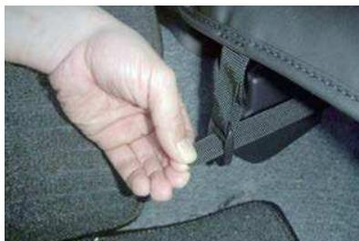
**9** 引き出したベルトと、6番で引き出した生地が付いているバックルを固定します。ベルトの固定方法は10番を参照して下さい。
