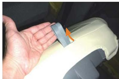
5 シートを跳ね上げる際に使用するベルトをカバーの加工穴から取り出します。
