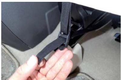
15 シートの背面からベルトを引き出します。引き出したベルトを4番で引き出した生地に付いているバックルに通して固定します。
