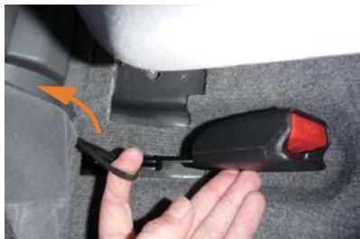
2 シートに付いているゴムに1番で固定を外したシートベルトが通っているので、ゴムからシートベルトを抜き出します。
