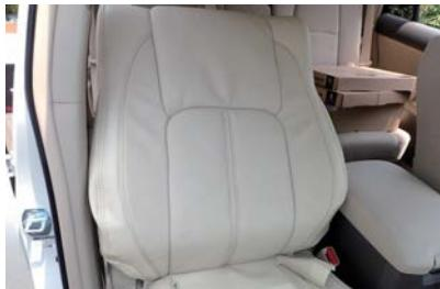
1 カバー側面のファスナーを開いた状態で、シートのラインに合わせてかぶせます。
