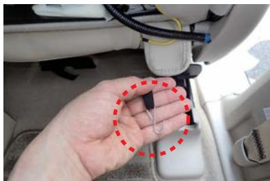
17 4番で引き出した生地の端にゴムが付いています。ゴムに付属の金属フックを取り付けて、金属フックをシート裏にある金属フレームに引っ掛けで固定します。
