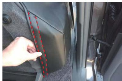
4 外側のシート裏も、2番と同様にマジックテープを直接シートの裏に貼り付けて固定します。
