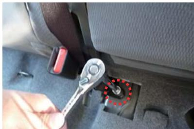
1 始めに中央のシートベルトの固定を外します。
