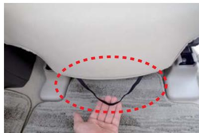
11 カバー背面下に付いているゴムを、5ページ1番で外した生地を固定していたゴムと同様の位置に引っ掛けで固定します。
