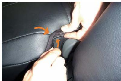
7 アームレストの付け根部分でカバー側面のファスナーを生地を内へ寄せながら、慎重に閉じます。
