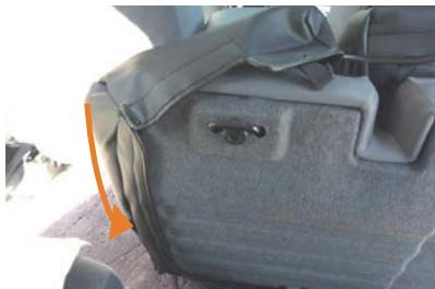
1 シートを跳ね上げて、シートの内側にカバーを引っ掛けるようにかぶせます。
