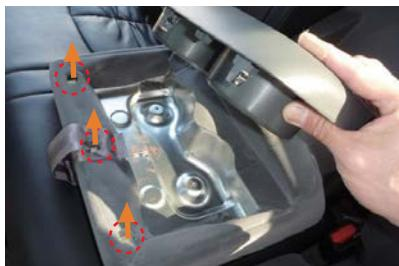
3 ドリンクホルダーは2番のネジと、図の丸印部分3か所にクリップで固定されています。
