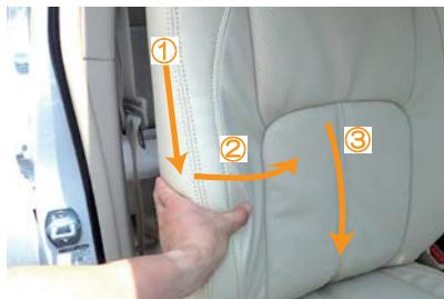
9 ①→②→③の手順で側面の生地をシートに馴染ませていきます。シート中央の下に余った生地は、再度6番で引き出したようにシートの背面から引き出します。
