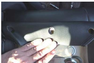
9 ドリンクホルダーのクリップを固定する穴に、カバーの加工穴を合わせます。
