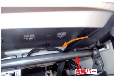
14 ベルトを入れ込む際は、ベルトをスライドレバー・シート裏にある金属バーの上を通すようにして下さい。
