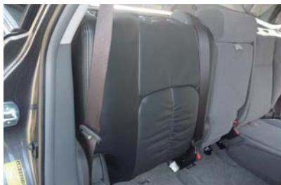
12 始めに外したシートベルトを元通りに固定します。2番のゴムはシートカバーに同様のゴムが付いているので、そちらにシートベルトを通して下さい。
