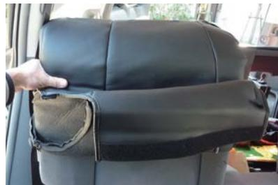
5 カバー外側面のファスナーを開いた状態でシートのラインに合わせてかぶせます。
