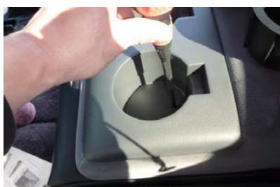
2 カップを外すと内側にネジがあるので、ドライバーを使用してネジを外します（2か所）。
