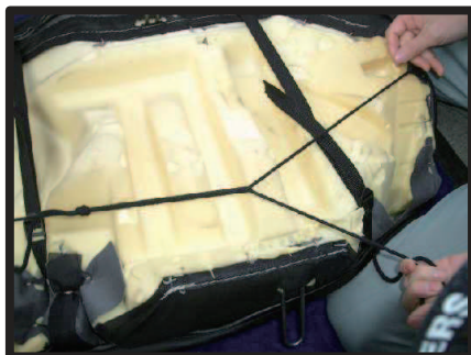
④カバー両横のヒモは、一方で輪を作り、もう一方のヒモを輪に通して、引き絞って結びます。
