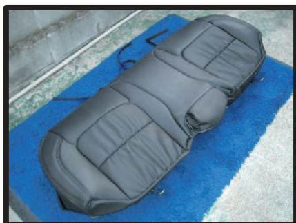
②カバーをシートのラインに合わせてかぶせます。
